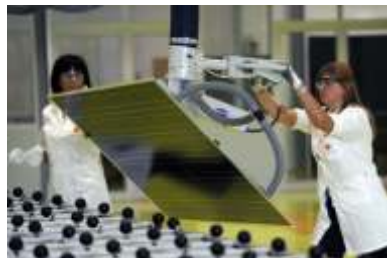
elevador de fácil manuseamento easy lift handling station
