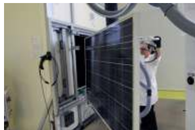
estação de flash test flash test station
